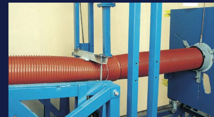
Stav při zátěžové zkoušce: Těsnost 100% při deformaci 30%
