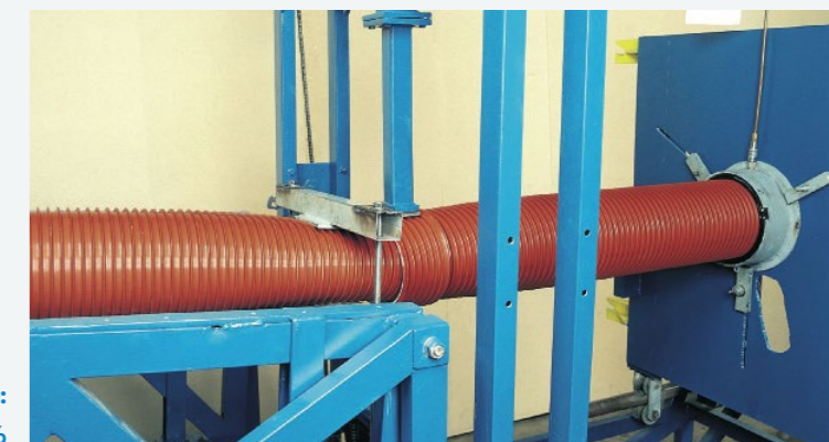
Stav při zátěžové zkoušce: Těsnost 100% při deformaci 30%
