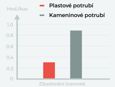
Zdroj: Směrnice inženýrského stavitelství na délku pokládky tvarovek DN 200 (Německo)
