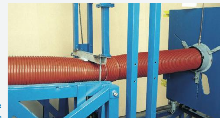
Stav při zátěžové zkoušce: Těsnost 100% při deformaci 30%
